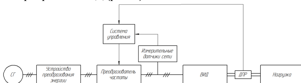
Рисунок 1. Электрическая структурная схема электропривода ВИД
