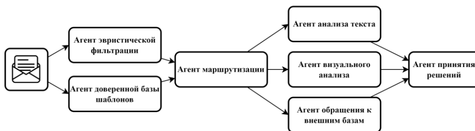
Рисунок 2. Гибридная архитектура обнаружения фишинга
