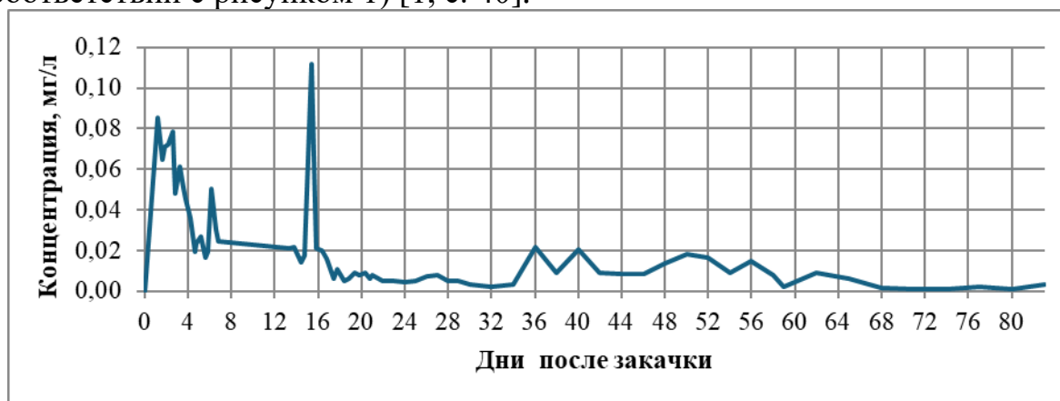
Рисунок 1 - Текущая концентрация индикаторов в попутно добываемой воде из скважины
