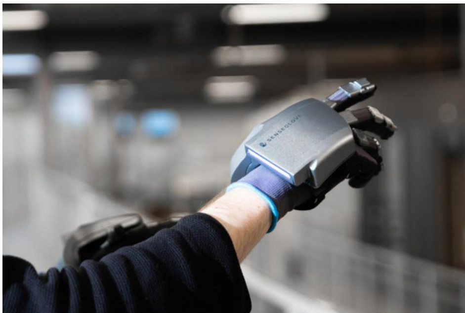
Рисунок 2. Гаптическая перчатка, которая передает ощущения от контакта с виртуальными предметами.
