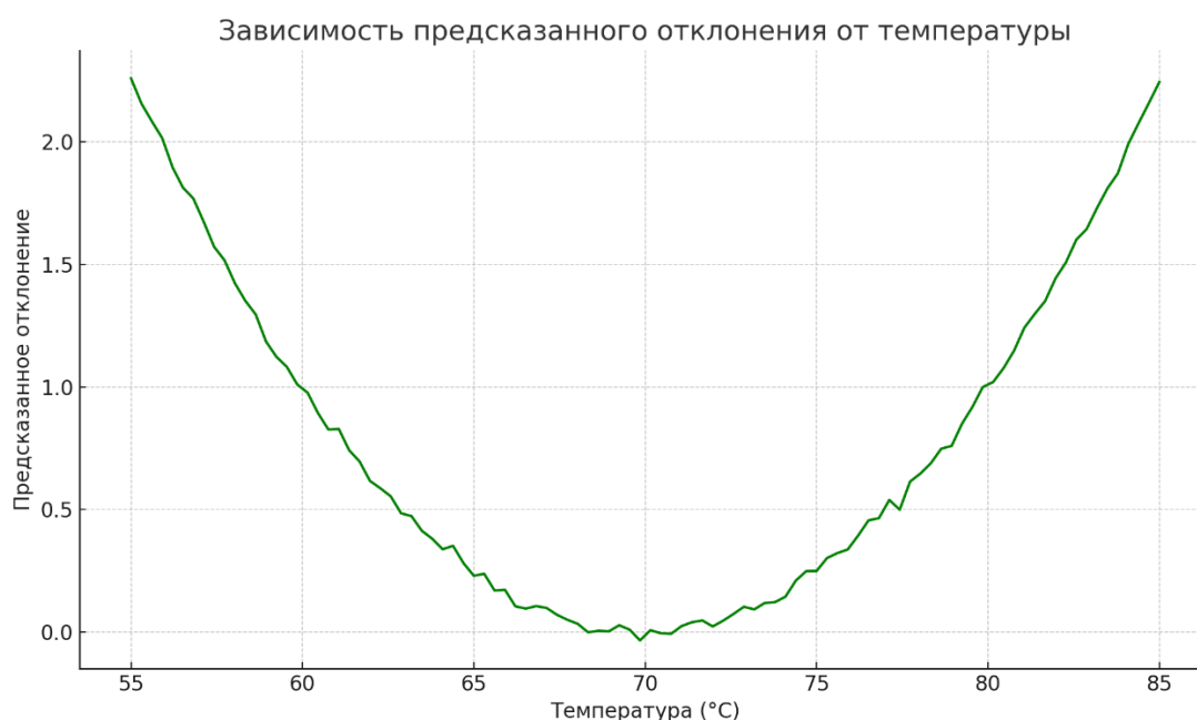
Рис. 2. Зависимость предсказанного отклонения от температуры при фиксированных давлении и скорости
