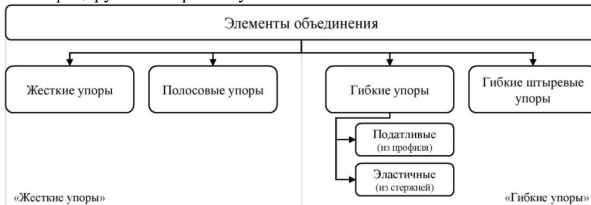
Рисунок 2 – Система классификации элементов объединения СТЖБ ПС
