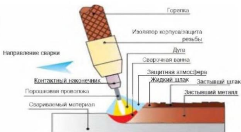
Рисунок 1. Схема процесса сварки самозащитной порошковой проволокой
