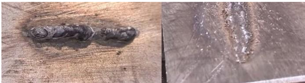
Рисунок 2. Высокая и низкая скорости подачи проволоки
