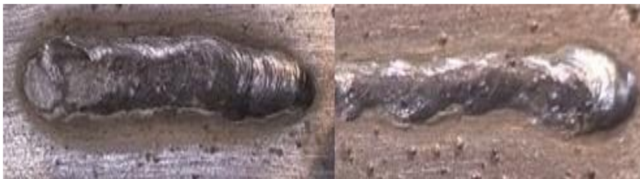
Рисунок 3. Низкая и высокая скорость сварки
