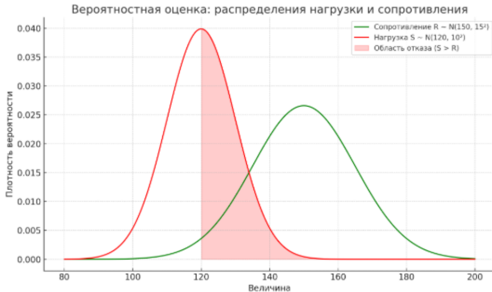
Рисунок 1. График вероятностного распределения нагрузки с областью отказа
