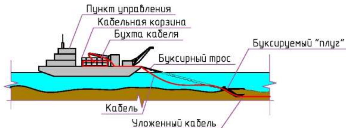
Рисунок 1. Схема укладки кабеля по дну водоема
