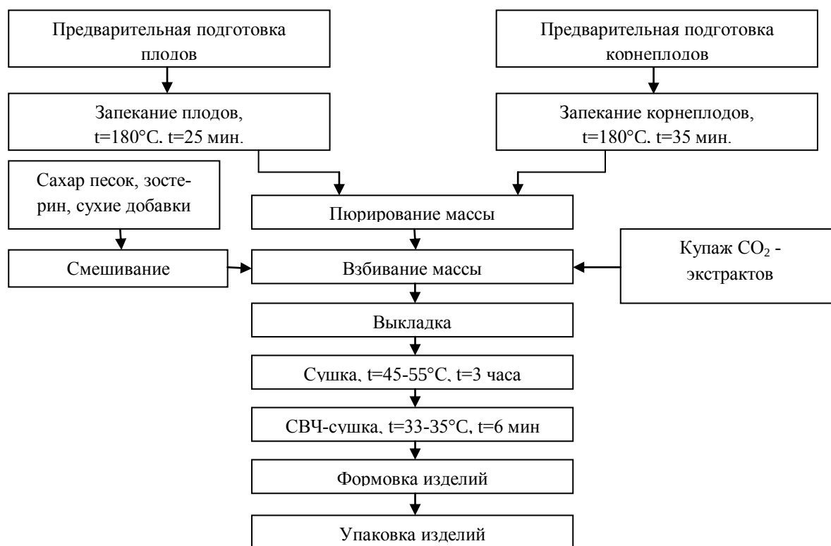
Рисунок 2. Технологическая схема производства пастильных снеков.
